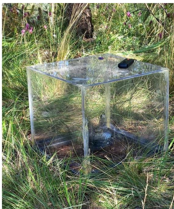
Рисунок 1 – Закрытая герметичная камера объемом 0,06 м<sup>3</sup> с внутренним вентилятором для измерения скорости эмиссии диоксида углерода
