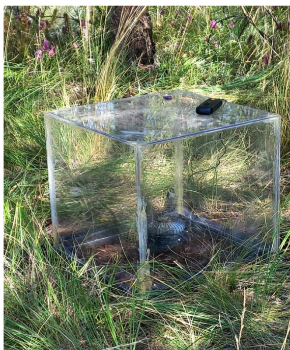
Рисунок 1 – Закрытая герметичная камера объемом 0,06 м 3 с внутренним вентилятором для измерения скорости эмиссии диоксида углерода
