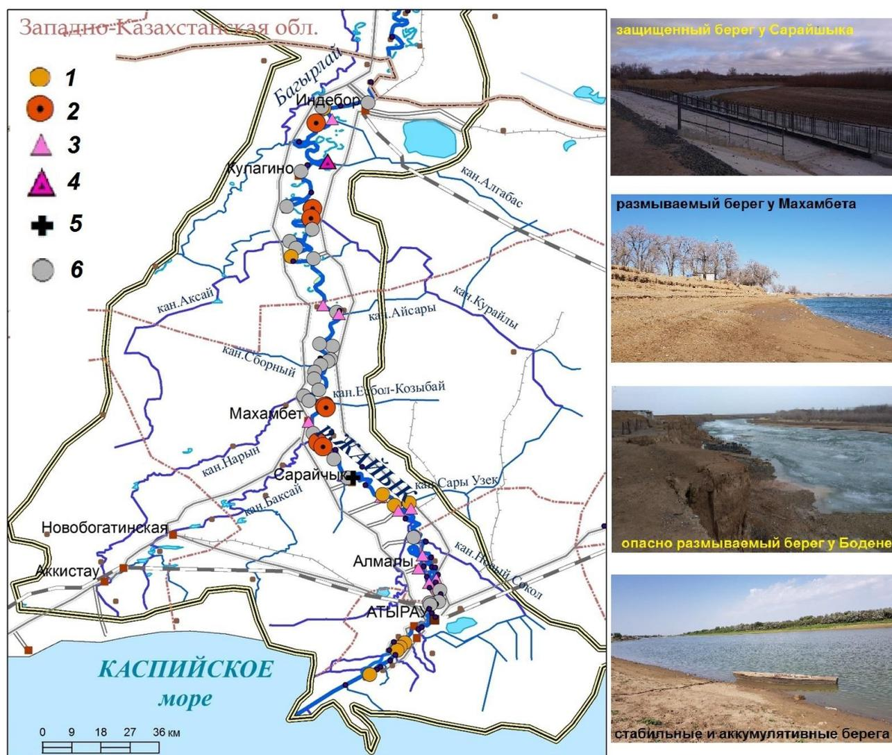
Рисунок 4 – Типы берегов р. Урал по интенсивности и тенденции их переформирования на участках размещения водозборных сооружений и населенных пунктов, по данным обследования в 2019 г.
