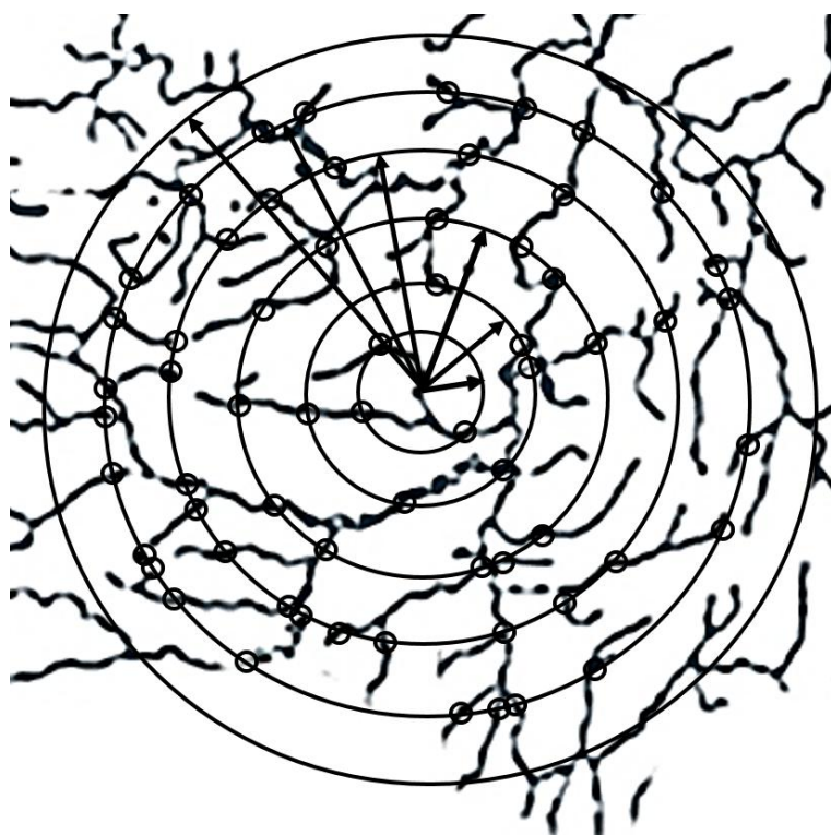
Рисунок 7 – Определение фрактальной размерности речной сети Канторовским методом [2]
