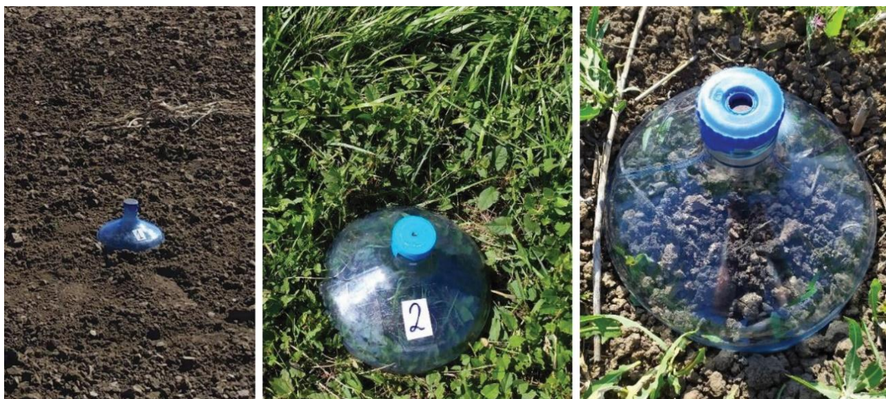
Рисунок 2 – Накопительные камеры – ловушки, установленные для определения потоков метана с почв с невысокой или отсутствующей растительностью
